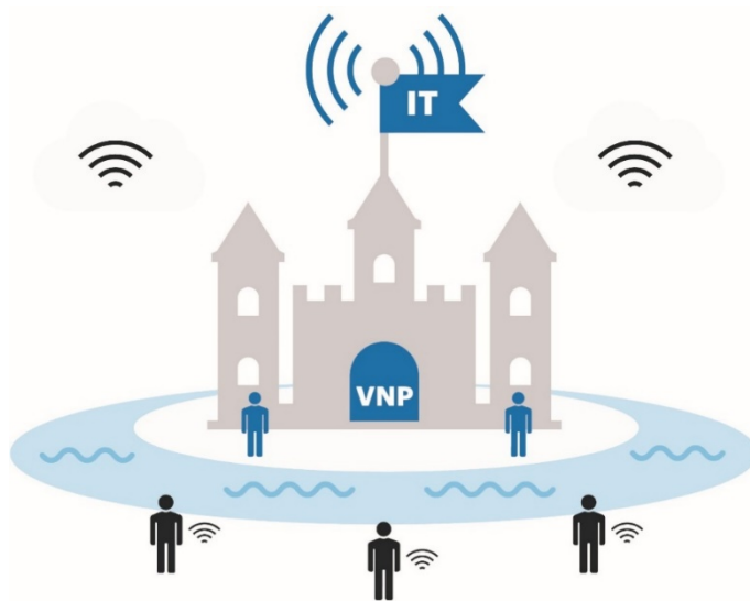
Figur 6.2 Slott- og vollgravmodellen for sikkerhet. Så snart brukeren er på innsiden av slottet har den vide fullmakter.
