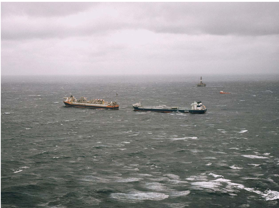
Figur 3-4 Produksjonsskipet på Nornefeltet (til venstre) sammen med et skyttelskip, som transporterer olje til et raffineri, samt en borerigg (bakerst i bildet) og et nødfartøy (lite rødt fartøy til høyre). ©Statoil
