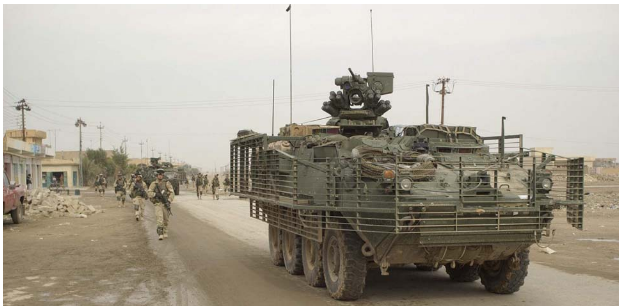
Figur 4.8 Stryker har fått påmontert et gitter for å beskytte mot angrep fra RPG
