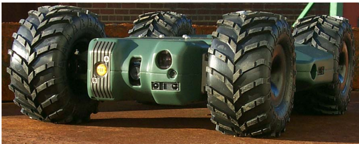
Figur 4.6 Dragon Runner er et lett bærbart kjøretøy (ca. 4,5 kg) som er blitt benyttet i Irak og Afghanistan. Dragon Runner er utviklet ved USMC Warfighting Lab
