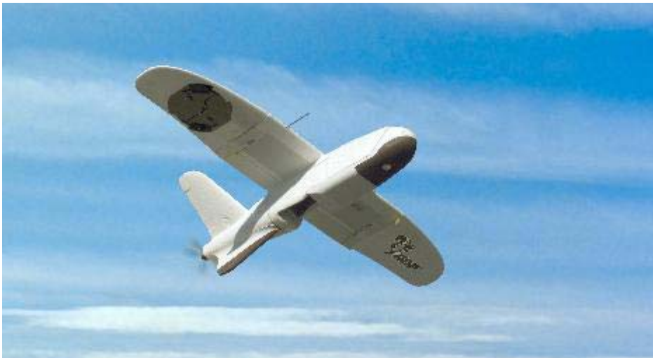
Figur 4.5 Den lille amerikanske overvåkings-UAVen Desert Hawk får stadig flere oppgaver. I Irak brukes den også til å droppe røykgranater. Vingspennet er ca. 130 cm (Bilde: US Air Force)
