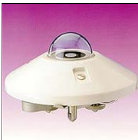
Figur 3.10 Eksempel på bredbånd radiometer, CUV3 fra Geneq, Montreal, Canada (Kilde: www.geneq.com )
