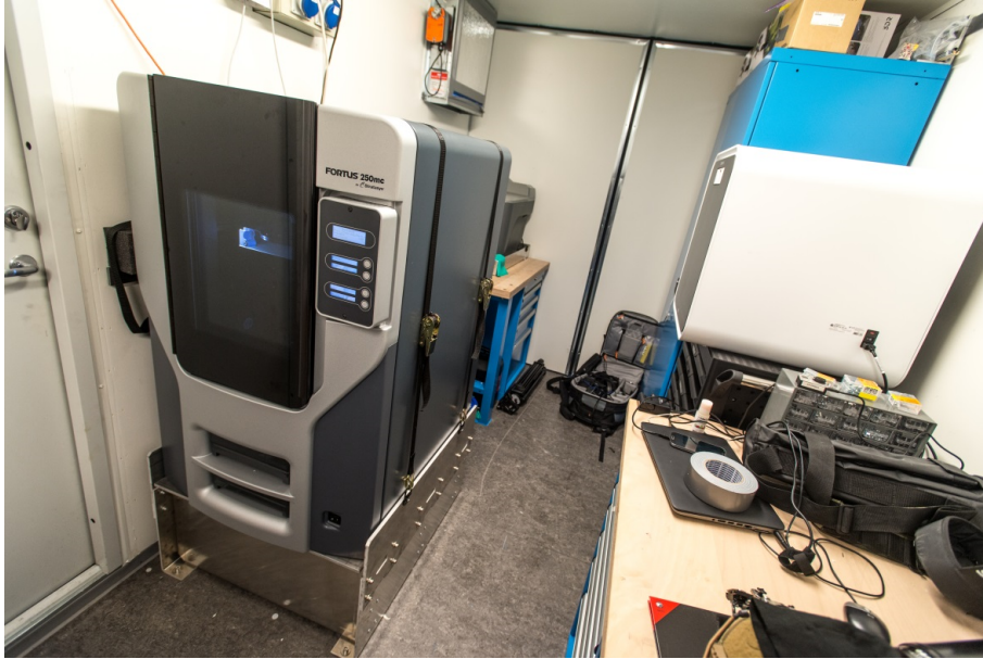
Figur 2.2 Innsiden av kontaineren. Stratasys Fortus 250mc til venstre i bildet.
