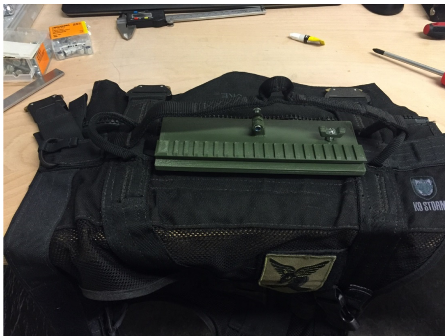
Figur 3.11 Montasjeskinne for kamera og annet utstyr på hund.
