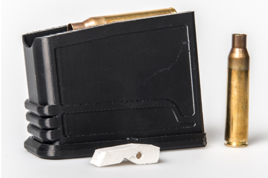
Figur 3.5 6-skudds magasin for MRAD. Det originale magasinet kan butte i bakken når våpenet er montert på 2-fot. Dette kortere magasinet løser problemet. I front av bildet sees modifikasjon av eksisterende utløsermekanisme som forhindrer utilsiktet utløsning av magasin.
