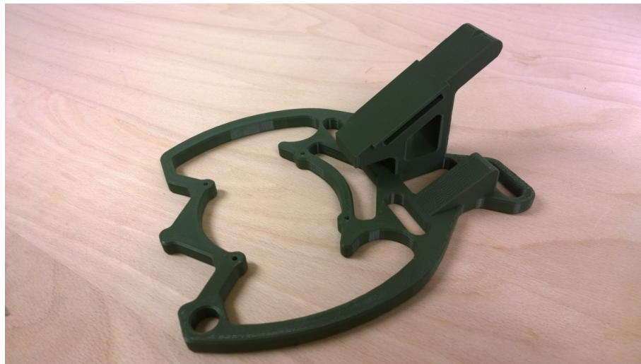
Figur 4.1 Monteringsløsning for kompass og stoppeklokker ved angrepssvømming.
