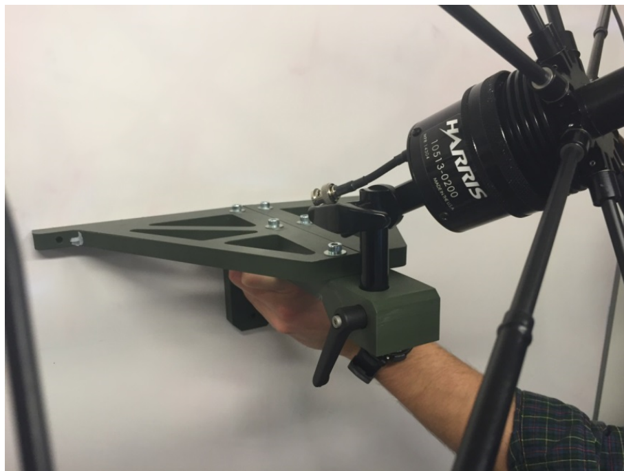
Figur 3.8 Antennefeste for Tacsat. I enkelte tilfeller er det er ønskelig med en fast montering i stedet for midlertidig stativløsning. Beskytter utstyret og gir mer stabil kommunikasjon.
