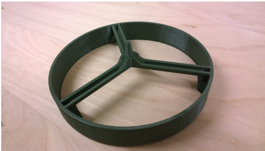
Figur 3.2 Prototype av veggledning («Le bomba») for utplassering av C4. Sikrer at tre detonatorer får lik innbyrdes plassering i forhold til et senterpunkt. Potensiale for redusert bruk av sprengstoff i forhold til dagens løsning. Løsningen kan skaleres og flere veggledninger kan monteres sammen i en sirkelformasjon.
