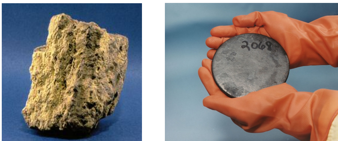
Figur 5.1 Uranmalm til venstre og høyanriket uranmetall til høyre. Foto: United States Government, offentlig eiendom.
