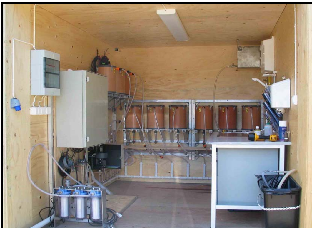
Figur 2.1 Feltlaboratorium for testing av filtermedier for rensing av vann forurenset med tungmetaller
