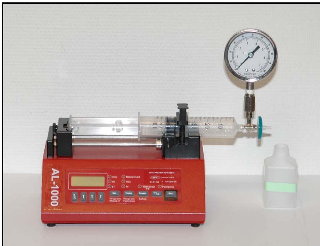
Figur 2.7 Sprøytepumpe og trykkmåler som ble benyttet for filtrering av vann med 0,45 \mu\text{m} filter
