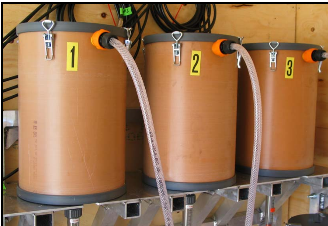
Figur 2.3 Kolonner for testing av filtermedium med oppstrøms vanngjennomstrømning
