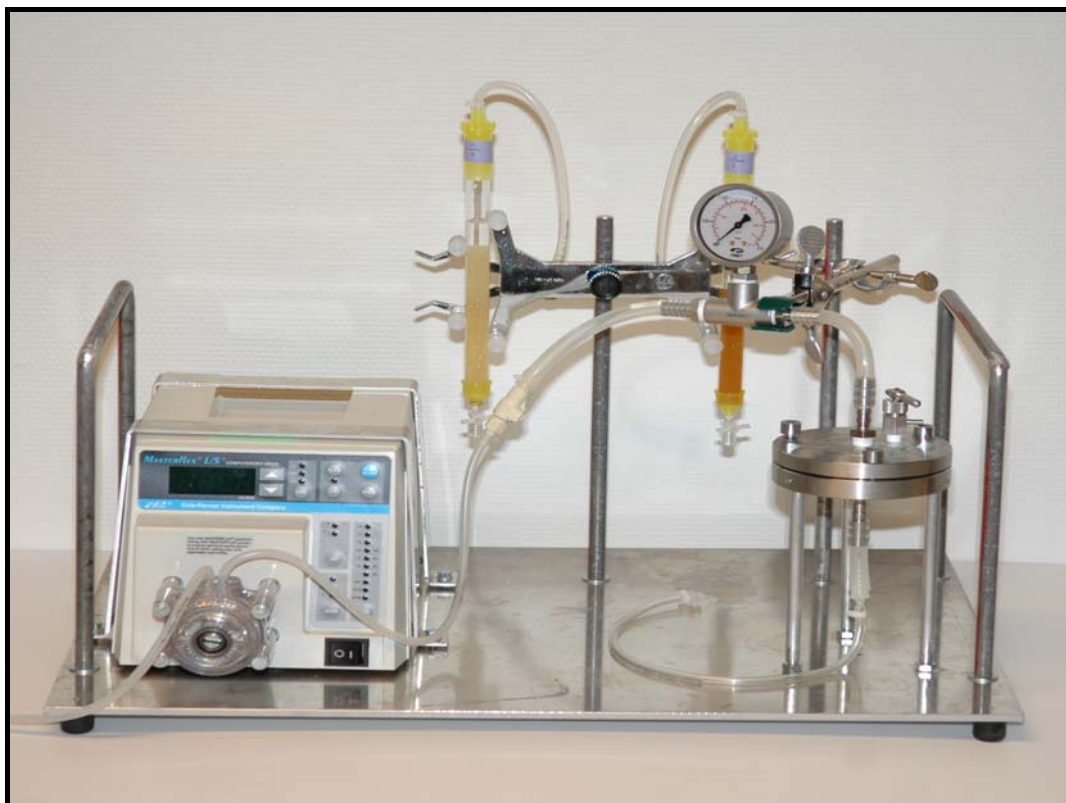
Figur 2.8 Pumpe, Ionebytter og filterholder for 0,45 \mu\text{m} filter med diameter på 90 mm
