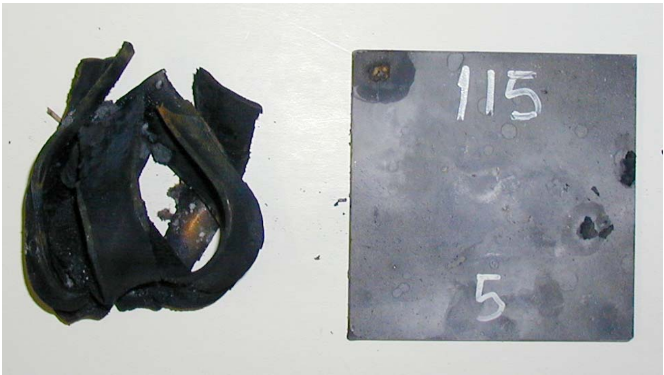
Figur 3.12 Skudd 4, rør 5 med PBXN-109 RS-RDX Ch. 167/03, 115 kort, ikke omsatt.
