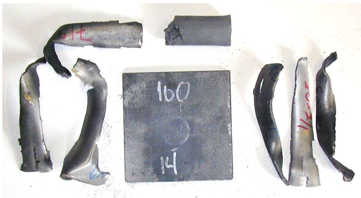
Figur 3.23 Skudd 14, rør 14 med PBXN-109 RS-RDX Ch. 719/03, 100 kort, ikke omsatt.
