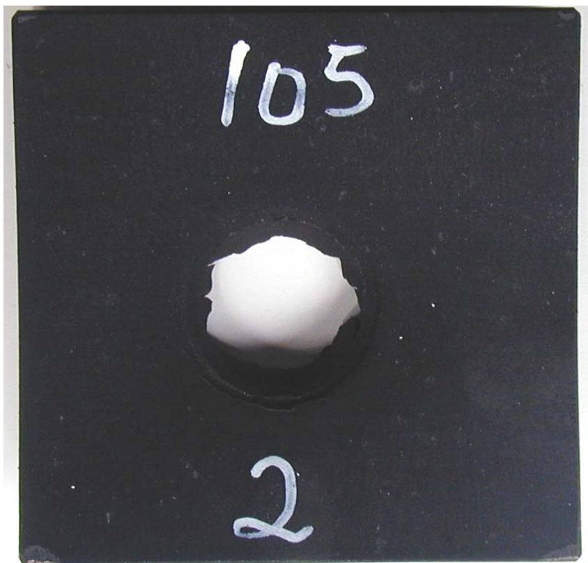
Figur 3.10 Skudd 2, rør 2 med PBXN-109 RS-RDX Ch. 167/03, 105 kort, omsatt.
