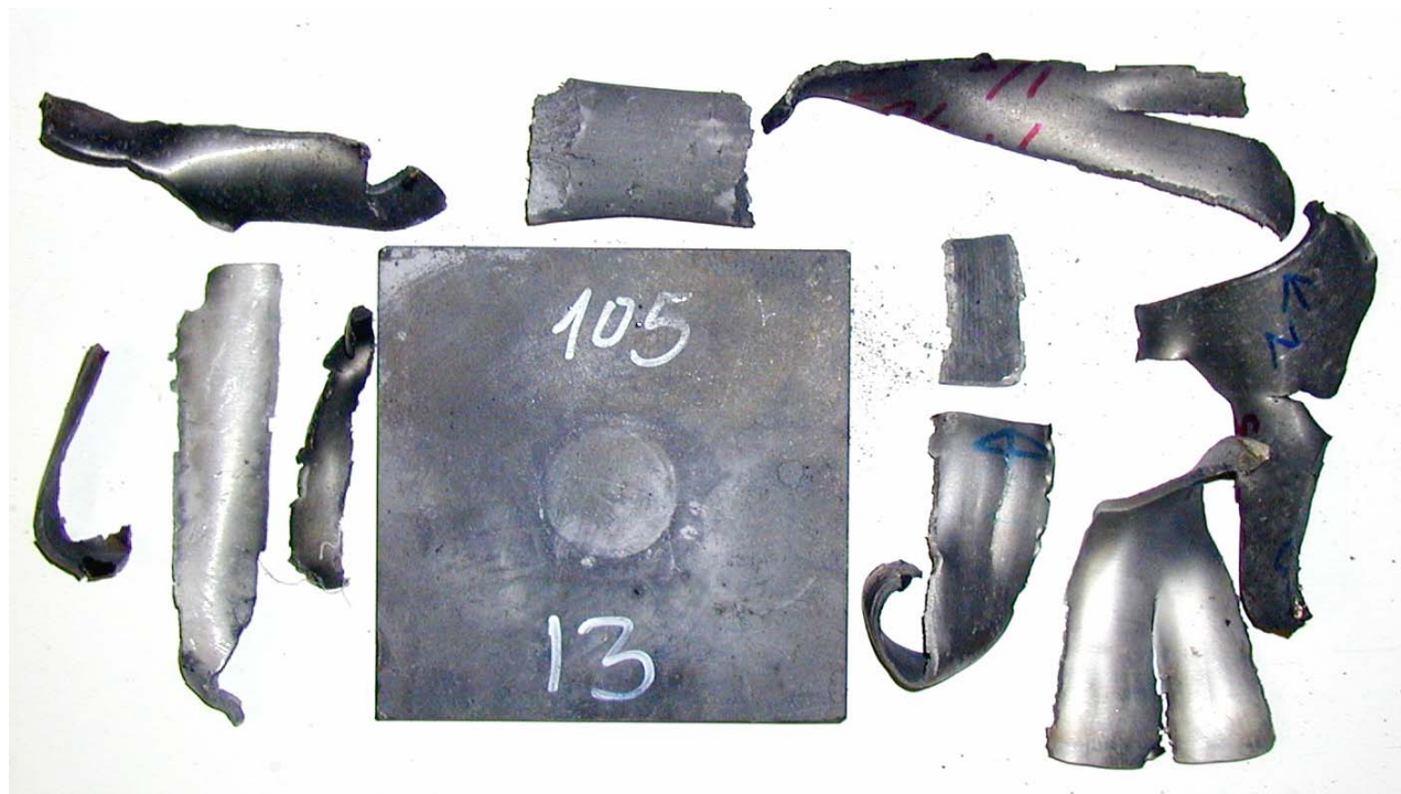
Figur 3.22 Skudd 13, rør 13 med PBXN-109 RS-RDX Ch. 719/03, 105 kort, ikke omsatt.
