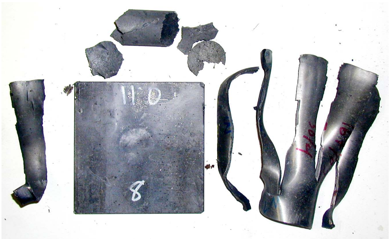
Figur 3.15 Skudd 7, rør 8 med PBXN-109 RS-RDX Ch. 167/03, 110 kort, ikke omsatt.
