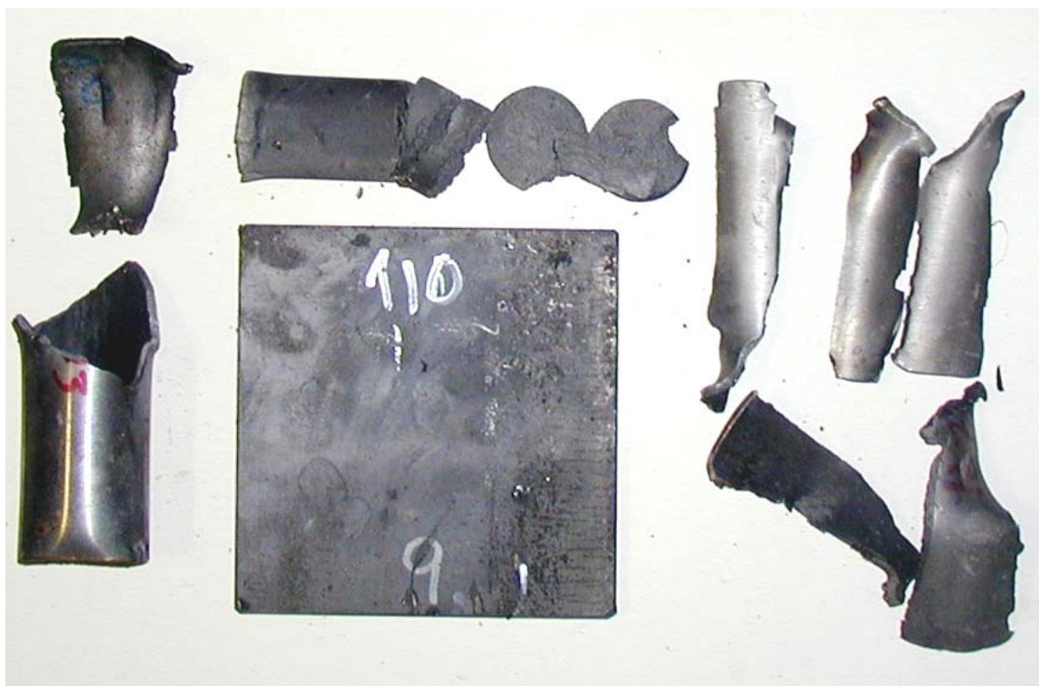
Figur 3.17 Skudd 9, rør 9 med PBXN-109 RS-RDX Ch. 167/03, 110 kort, ikke omsatt.
