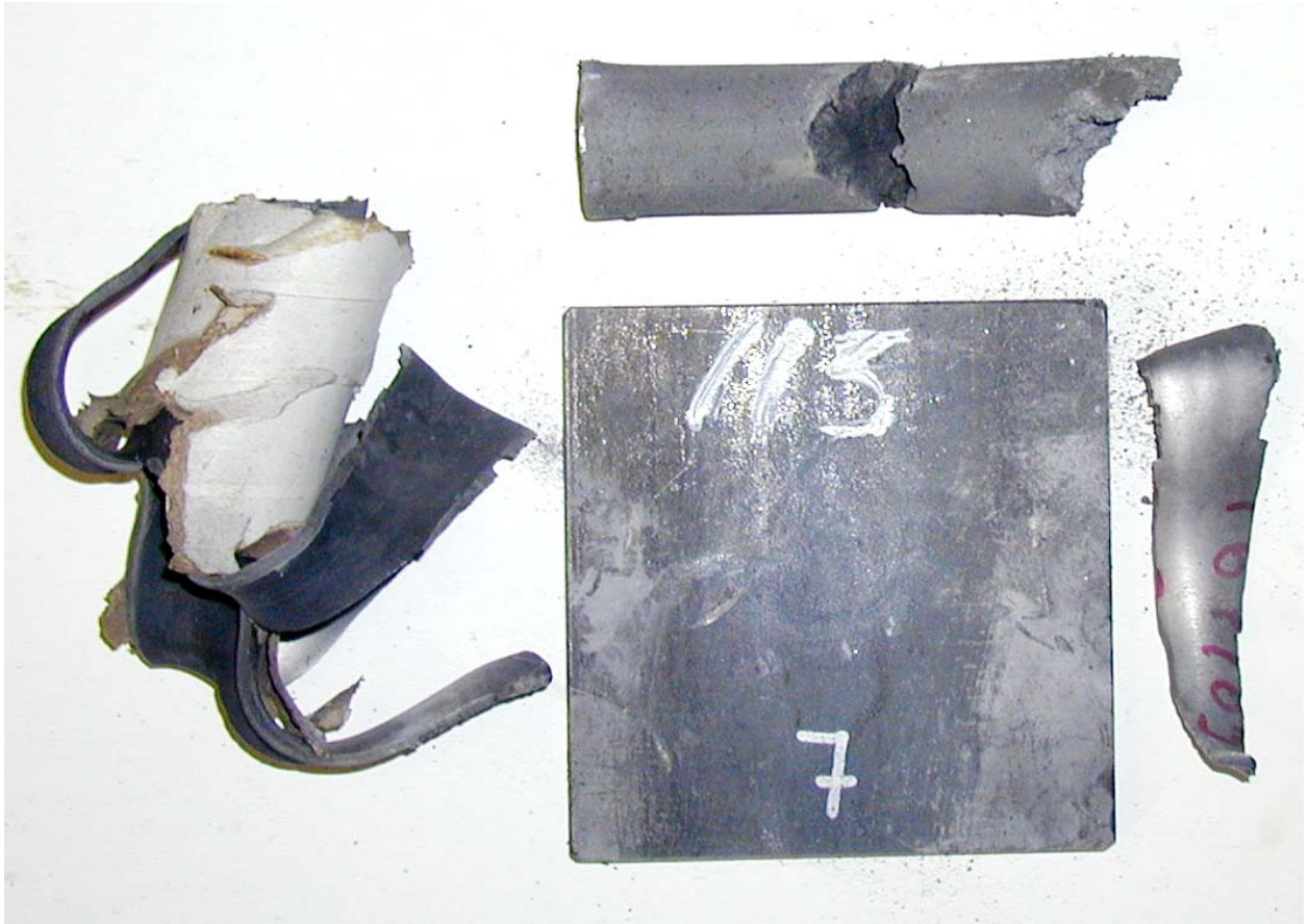
Figur 3.14 Skudd 6, rør 7 med PBXN-109 RS-RDX Ch. 167/03, 115 kort, ikke omsatt.
