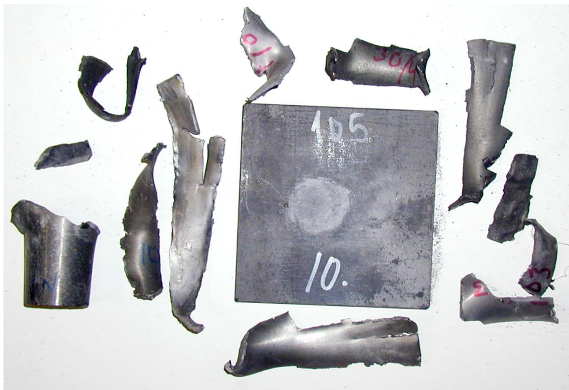
Figur 3.18 Skudd 10, rør 10 med PBXN-109 RS-RDX Ch. 167/03, 105 kort, ikke omsatt.
