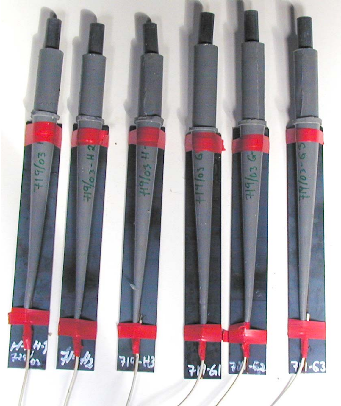
Figur 3.7 Bilde av testenhetene benyttet for bestemmelse av kritisk diameter for PBXN-109 med RS-RDX Ch 719/03 og Ch. 04/03 aldret ved 60°C i 12 mnd.
