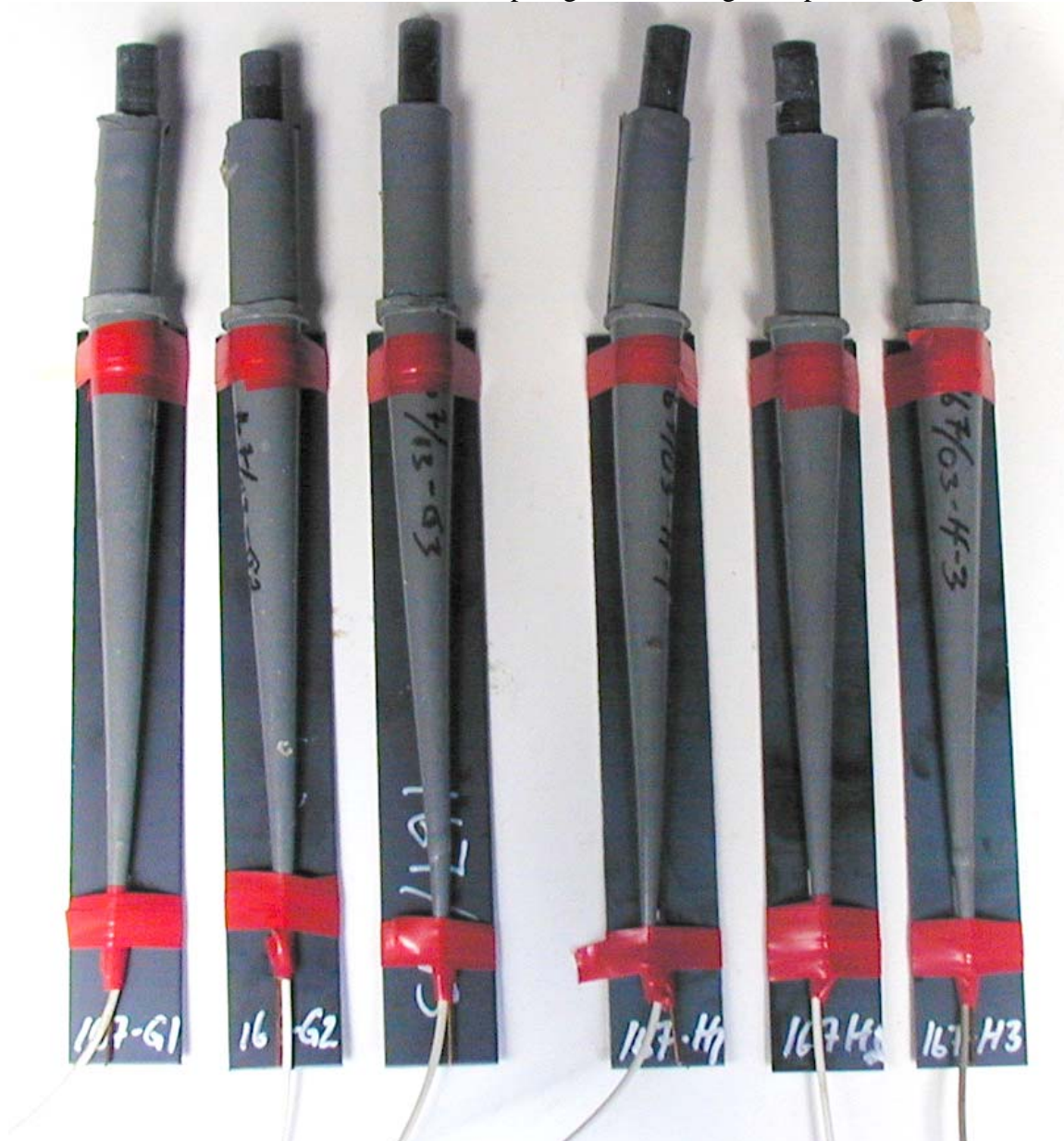
Figur 3.5 Bilde av testenhetene benyttet for bestemmelse av kritisk diameter for PBXN-109 med RS-RDX Ch. 167/03 og Ch. 04/03 aldret i 12 mnd ved 60°C.
