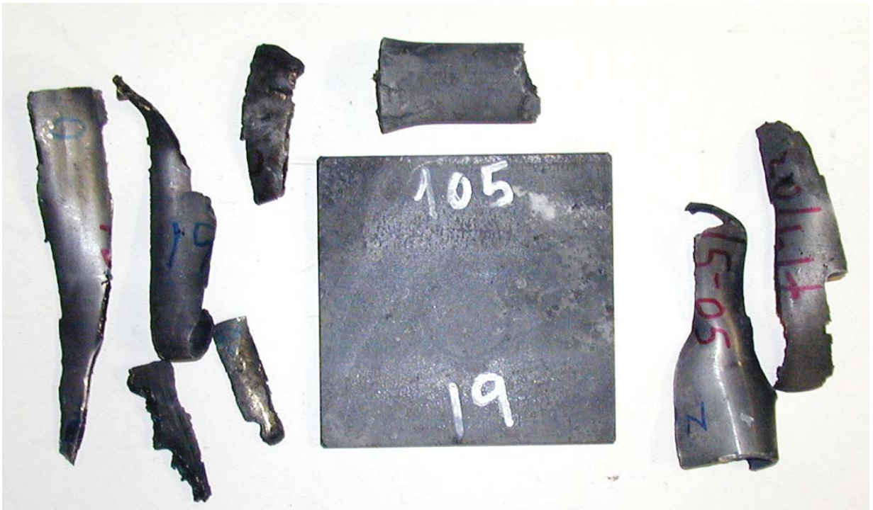
Figur 3.28 Skudd 19, rør 19 med PBXN-109 RS-RDX Ch. 719/03, 105 kort, ikke omsatt.
