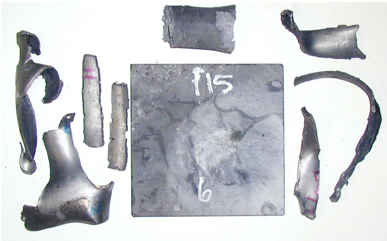
Figur 3.13 Skudd 5, rør 6 med PBXN-109 RS-RDX Ch. 167/03, 115 kort, ikke omsatt.
