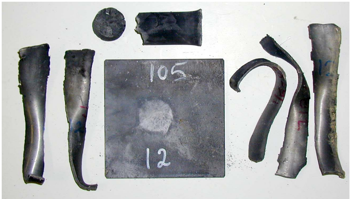
Figur 3.21 Skudd 12, rør 12 med PBXN-109 RS-RDX Ch. 719/03, 105 kort, ikke omsatt.
