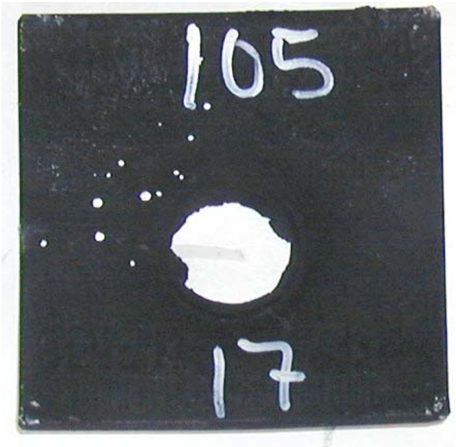
Figur 3.26 Skudd 17, rør 17 med PBXN-109 RS-RDX Ch. 719/03, 105 kort, omsatt.
