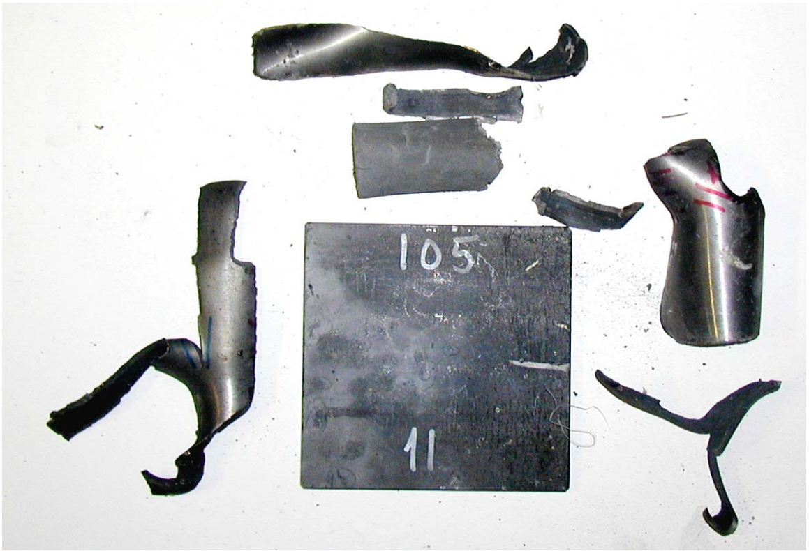
Figur 3.20 Skudd 11, rør 11 med PBXN-109 RS-RDX Ch. 719/03, 105 kort, ikke omsatt.
