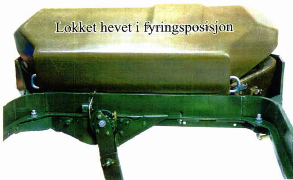
Figur 6.9. Granatkaster, 6-rørs, med hevet løkk før avfiring, sett bakfra.
