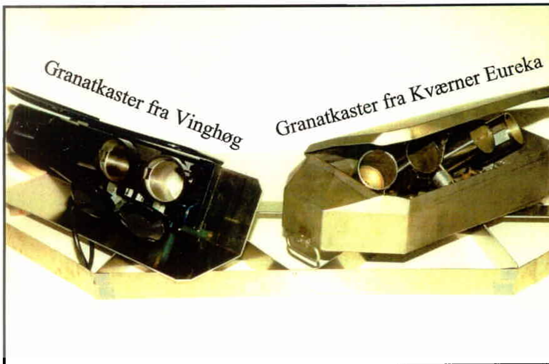
Figur4.1. Granatkastere utviklet av Vinghøg og Kværner Eureka påmontert stativ for sammenlignede feltutprøving på Bv 206.
