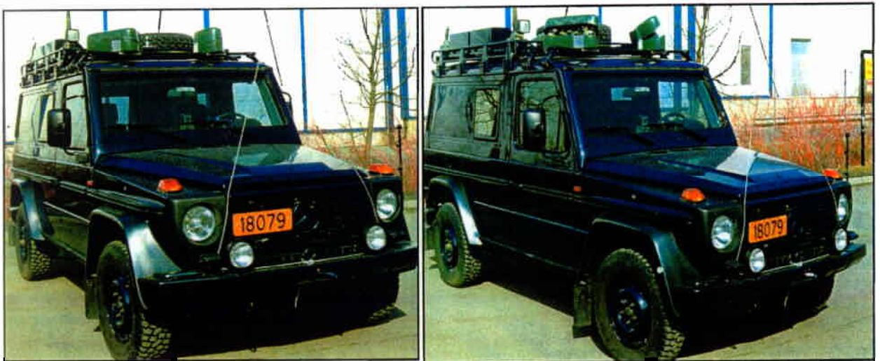
Figur 5.1. Granatkastere montert på HMKG eskortevoign. Til venstre er granatkasterne skjult og "nøytrale" i utseende og til høyre klar for avfiring.
