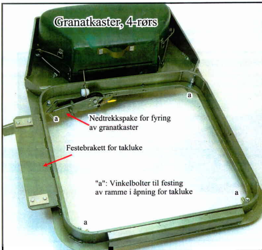
Figur 3.4. Granatkaster med takmontasje for Bv 20
