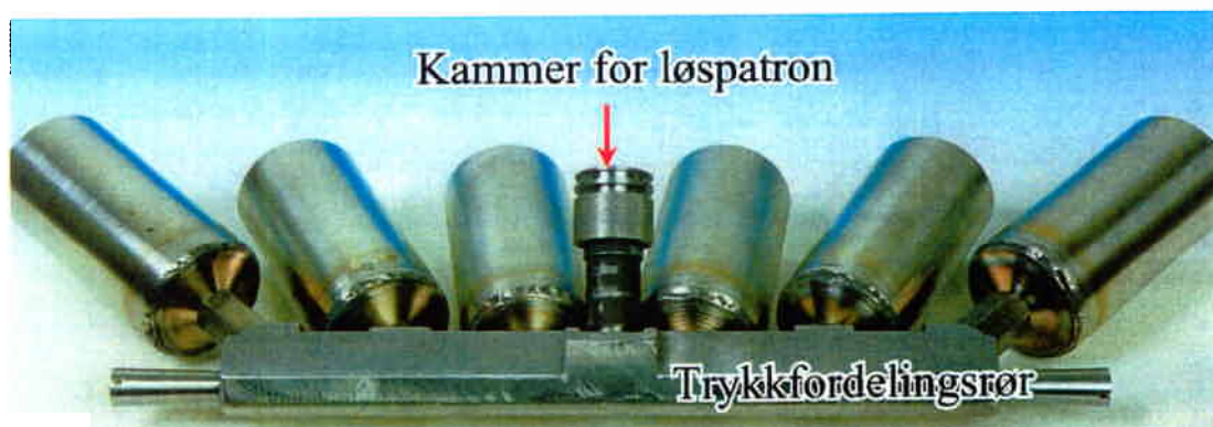
Figur 8.5. Utskytingsrør med trykkfordelingsrør og kammer før innstøping i polyuretan. Trykkfordelingsrøret har forlengede plugger i begge ender som etter innstøpingen er tilgjengelig og skrues ut ved rengjøring.
