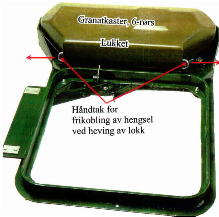
Figur 6.8. Granatkaster, 6-rørs, plassert på utvidet montasje for Bv 206
